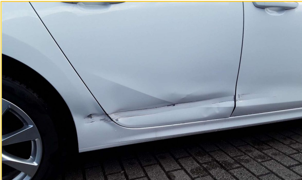
Bild 1: Werkstattbild mit Standard-Unfallschaden (Kasko) Rechte Seite, Betroffen sind die vordere rechte und hintere rechte Tür sowie das Kniestück der Seitenwand / hinterer Schwellerbereich
