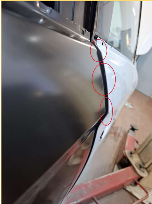
Bild 4+5: Werkstattbild, zu erkennen ist, dass von der Dichtung (karosserie-seitig) zur Rohbautür haben sich erhebliche Spaltmaße ergeben
