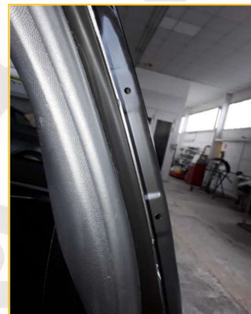
Bild 6+7: Werkstattbild, Spaltmaße nach Einstellung und fein Justage aller Anbauteile der gesamten rechten Seite
