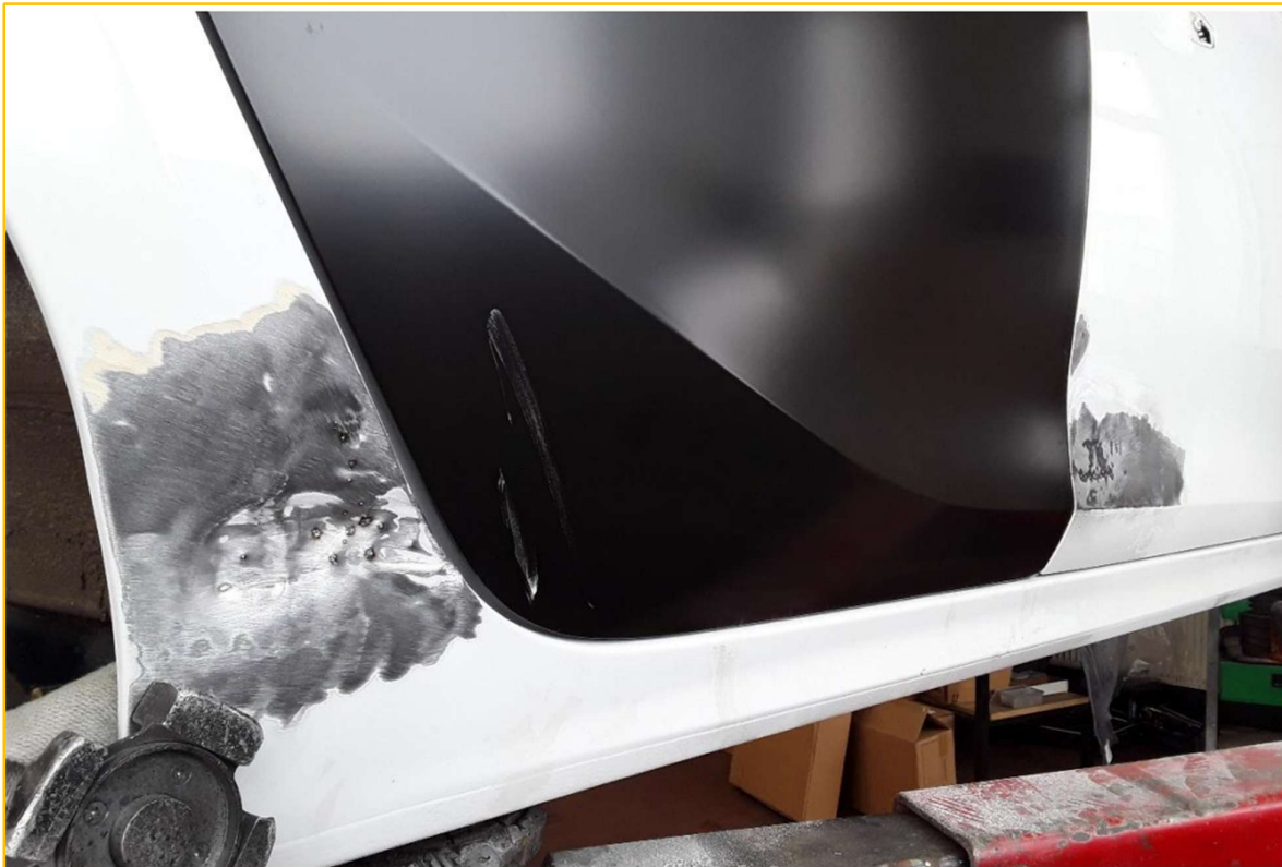
Bild 2: Werkstattbild, Neuteil Tür hinten rechts montiert zwecks Anpassarbeiten zu angrenzenden, instand zu setzenden Bauteilen
