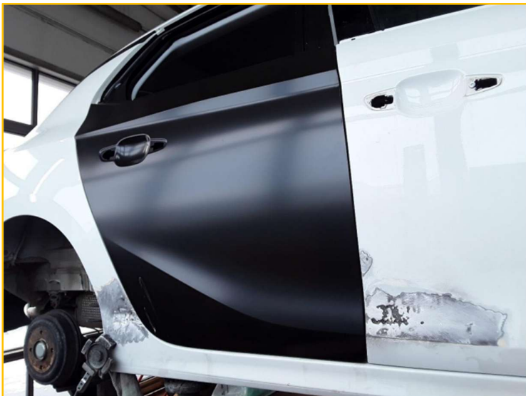
Bild 3: Werkstattbild, Frontalansicht nach eingesetzter neuer Rohbautür
