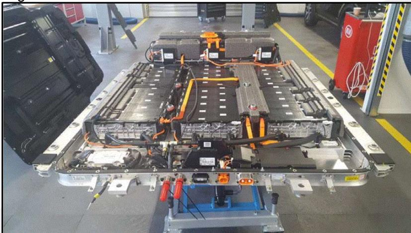
Bild 5: Quelle: ZDK, geöffneter Hochvoltakkumulator auf Absetzvorrichtung
