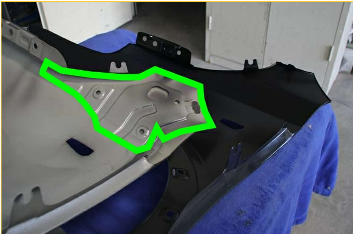
Bild 1: Werkstattbild Vergleich alter Kotflügel (silbergrau) mit Verstärkung und neuer Kotflügel schwarz ohne Verstärkung
