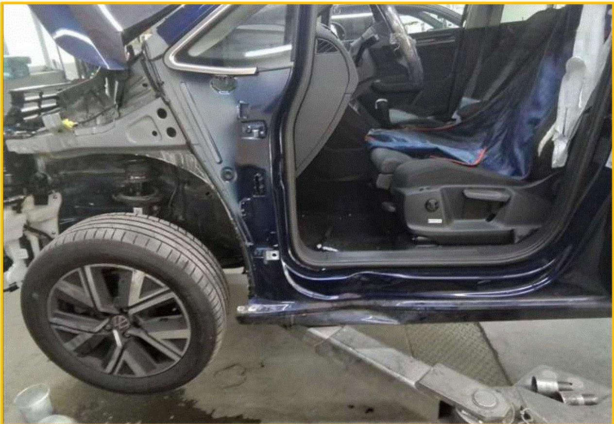
Bild 1: Werkstattansicht Seitenschaden Schweller links am VW Touran, Bj.2024 im teilweise freigelegten Zustand+Innenraumansicht
