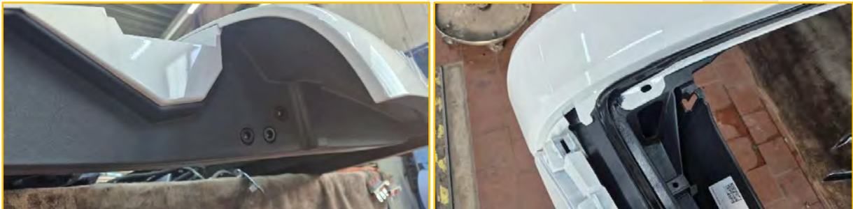
Bilder 3+4: Werkstattbilder, Detailansichten Neuteil Heckklappe Innenbereich seitlich und komplette Kleberaube auf dem Fenster-rahmen
