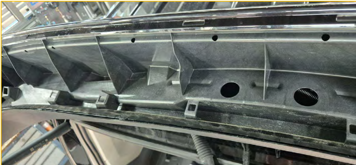
Bild 6: Werkstattbild, Innenansicht Rahmen Heckklappe mit Kabeldurchführungen
