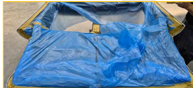
Bilder 13+14: Werkstattbilder, Abdekarbeiten für Lackierung Oberteil und Innenbereich der Heckklappe
