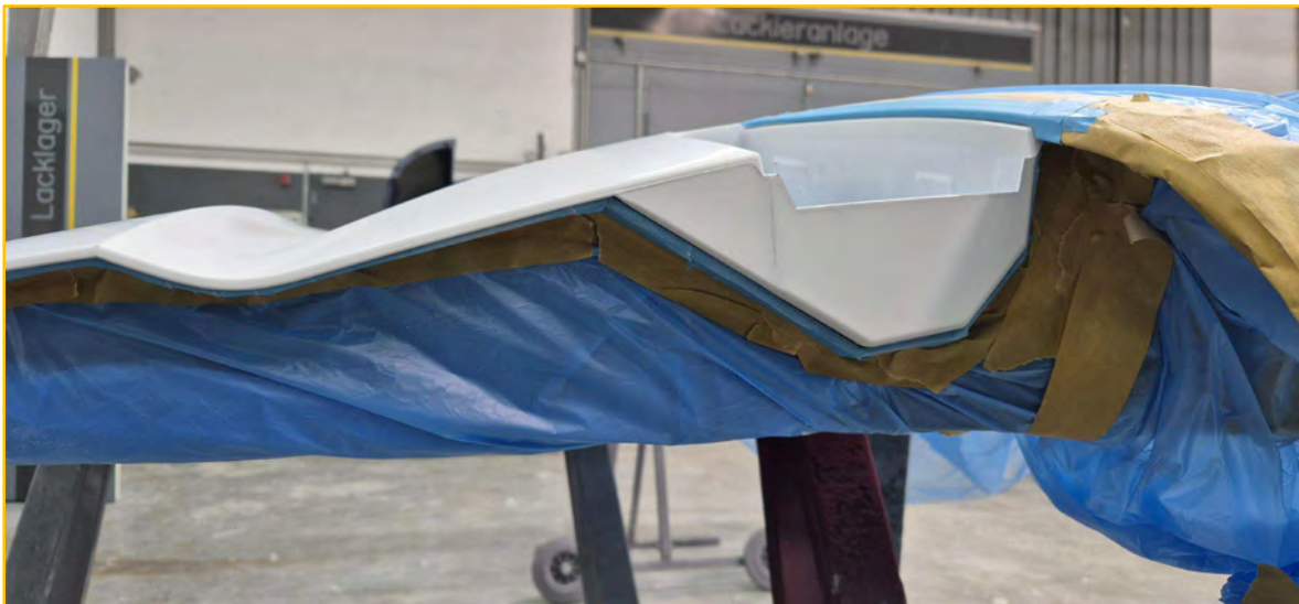
Bild 10: Werkstattbild Heckklappe Neuteil seitlich/innen abgedeckt zur Außenlackierung im Grundfarbton „Rot“
