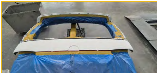
Bilder 13+14: Werkstattbilder, Abdekarbeiten für Lackierung Oberteil und Innenbereich der Heckklappe
