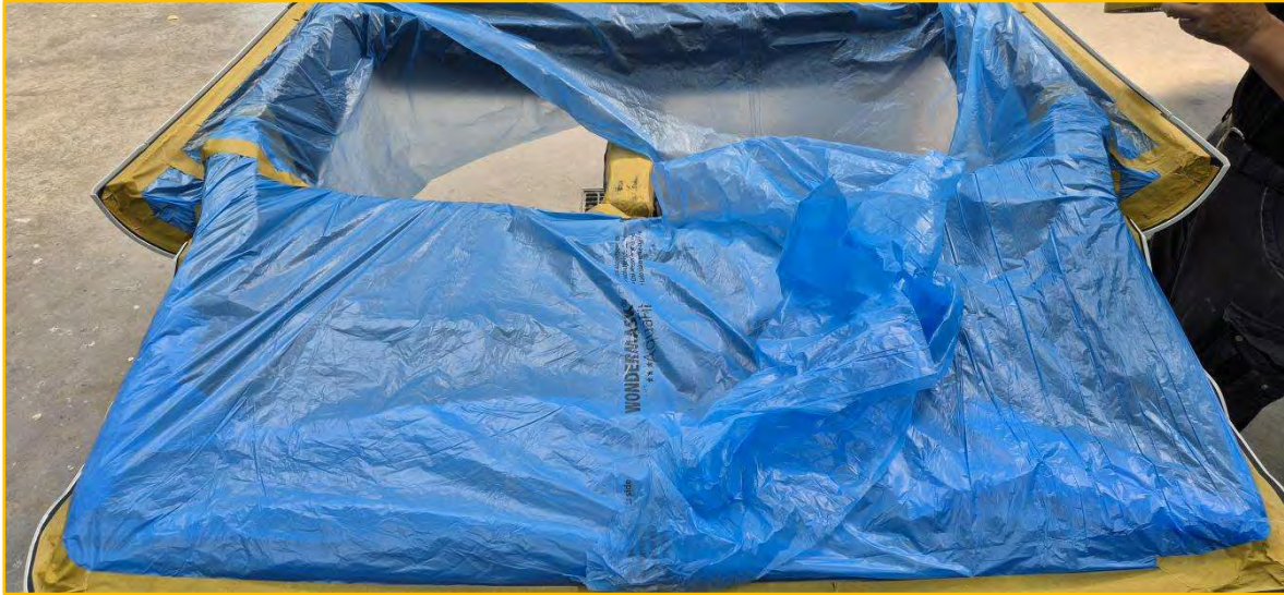
Bild 9: Werkstattbild, Ansicht Heckklappe Neuteil innen abgeklebt zur Außenlackierung/Grundfarbton „Rot“
