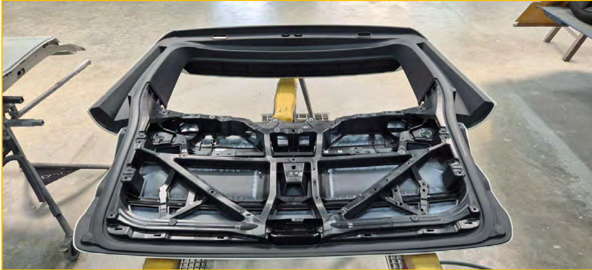
Bild 5: Werkstattbild, Anlieferungszustand Neuteil Heckklappe Innenansicht
