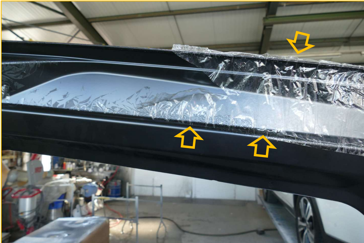
Bild 4: Werkstattbild Restfolien auf Karosserieteile
