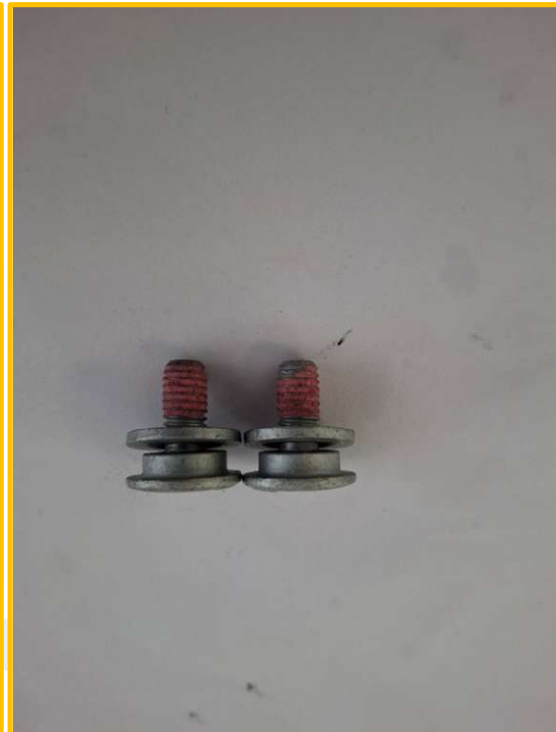
Bild 2: Selbstsichernde Schrauben am Türfeststeller
