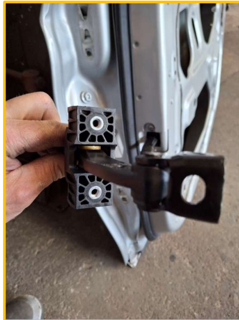
Bild 4: Türfangband im ausgebauten Zustand
