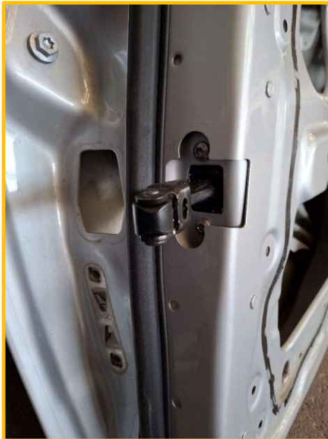
Bild 3: Türfangband im eingebauten Zustand
