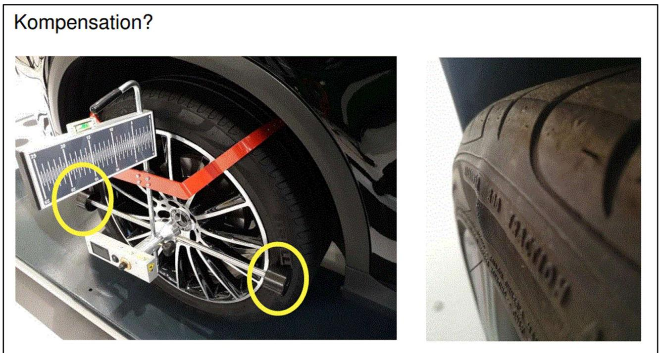
Bild 4 und 5: Reifen-laterale Formabweichung (Quelle: KTI FairRepair2)
