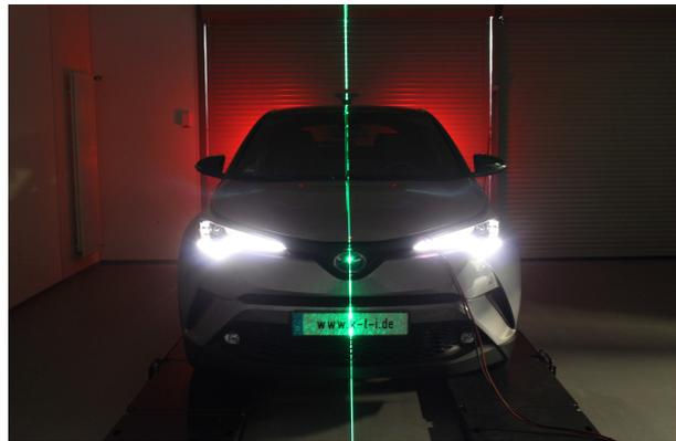
Zur Ausrichtung des Targets auf die Fahrzeuglängsmittlebene mittels Laser
