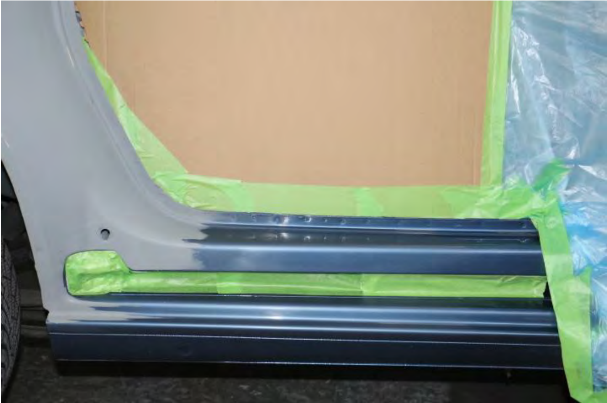
Abbildung 5: Detailansicht des zur Decklackierung vorbereiteten Kniestücks für das auslaufende Lackierverfahren.
