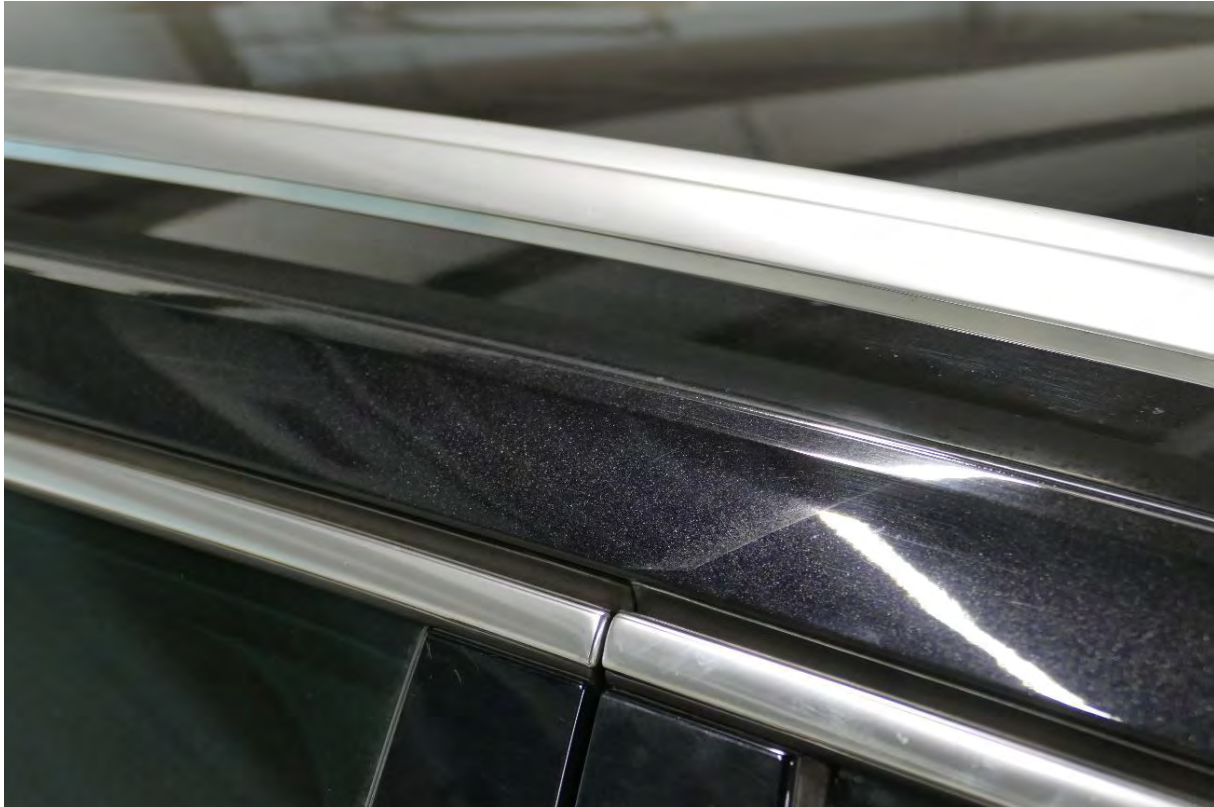
Abbildung 7: Beispiel einer scharfen Lackkante durch unsachgemäße Ausführung des auslaufenden Lackierverfahrens – Übergangsbereich nicht ausreichend dimensioniert und unterteilt.
