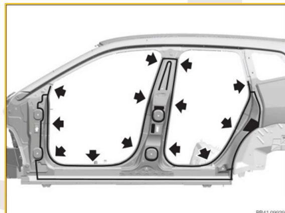
Bild 5+6: Auszug aus BMW-Reparaturinformation, Angaben zum Rückschneiden der bestehenden Kleberaube als Abstandshalter und deren Positionierung als Vorbereitung zur Montage CFK-Neuteil
