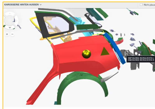
Bild 18+19: Auszug aus Audatex Capter Grafik, links Seitenrahmen Carbon, rechts Seitenteil hinten mit Abdeckung Wasserrinne bzw. Blende Heckleuchte ohne Hinweise
