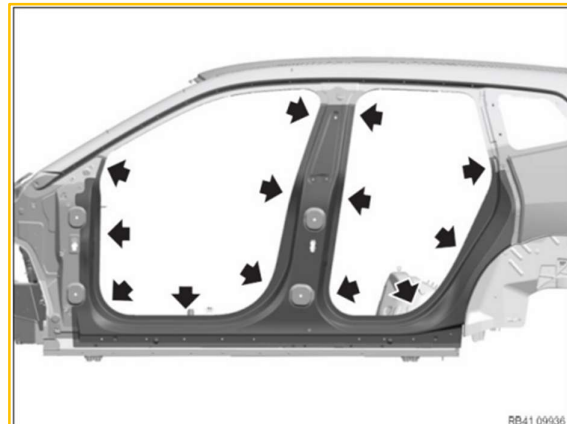
Bild 5+6: Auszug aus BMW-Reparaturinformation, Angaben zum Aufbringen des Klebstoffes und dem Anbringen der Kunststoffklammern und deren Positionierung auf den Abstandshaltern der Kleberaube zum Fixieren des CFK-Neuteils zur Montage
