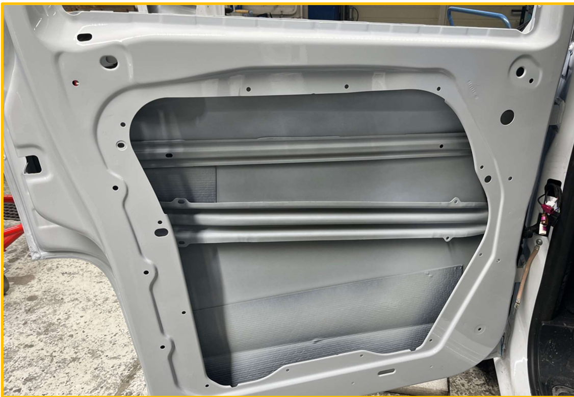
Bild 1: Werkstattbild Innenansicht Neuteil / Fronttür Mercedes Benz EQV mit aufgeklebten Dämmmaterial
