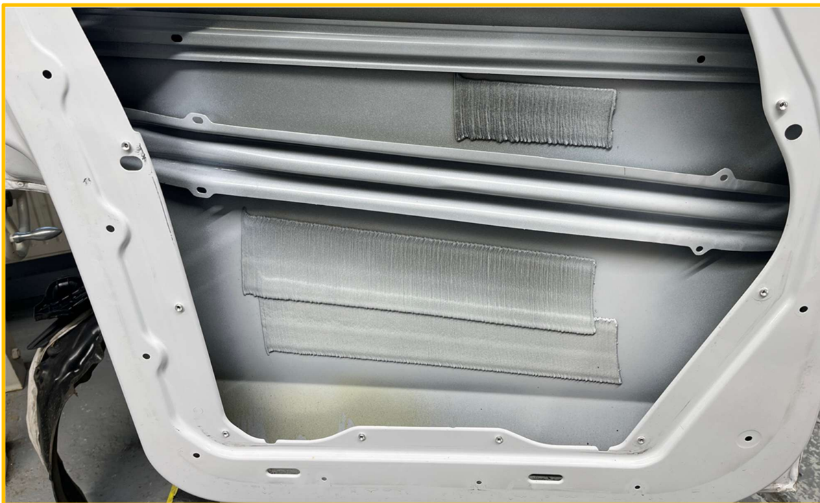
Bild 1: Werkstattbild Innenansicht Originalteil / Fronttür Mercedes Benz EQV mit spritzappliziertem Dämmmaterial
