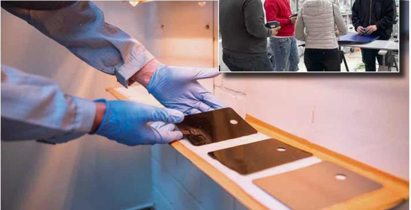
**Digitale Messgeräte zur Farbtonbestimmung setzen sich in Kombination mit moderner Farbsoftware in den Lackierbetrieben zunehmend durch. Viele Werkstätten haben erkannt, dass diese Tools im Vergleich zur traditionellen Farbtonbestimmung deutliche Vorteile haben.**
