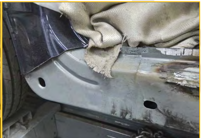
Bild 6: Anschluss Schwellerverstärkung an A-Säulenverstärkung
