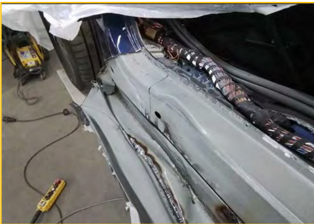
Bild 3: Ansicht Schweller/Einstiege links vorne nach Rückverformung Bild 4: Ansicht Schwellerverstärkung links, Anschluss an B-Säule
