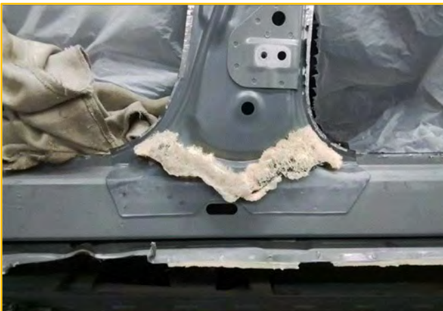
Bild 5: Anschluss Schwellerverstärkung an B-Säulenverstärkung
