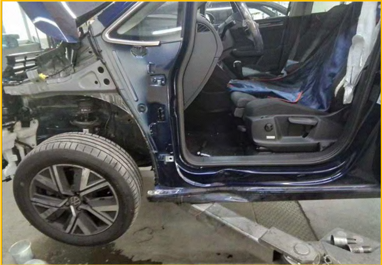
Bild 2: Werkstattansicht Seitenschaden Schweller links am VW Touran, Bj. 2024 im teilweise freigelegten Zustand
