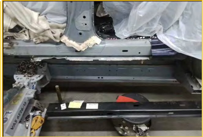
Bild 3: Ansicht Schweller/Einstiege links vorne nach Rückverformung Bild 4: Ansicht Schwellerverstärkung links, Anschluss an B-Säule
