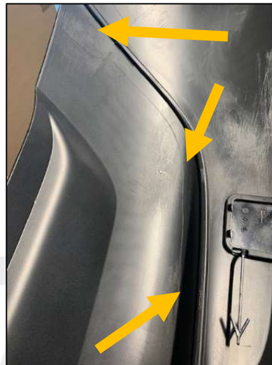
Bild 2: Bereich für Langlöcher/Innenansicht
