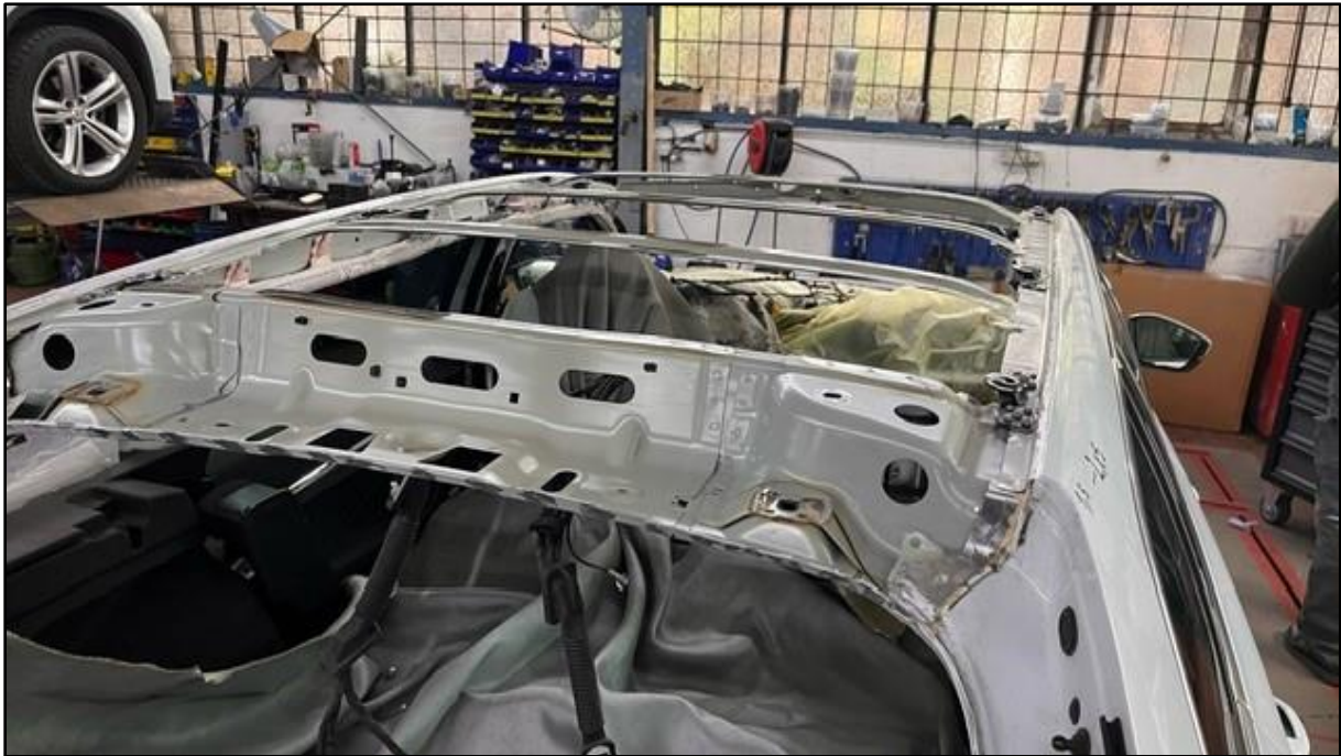
Bild 2: Werkstattaufnahme, Skoda Octavia Combi mit ausgebautem Dach
