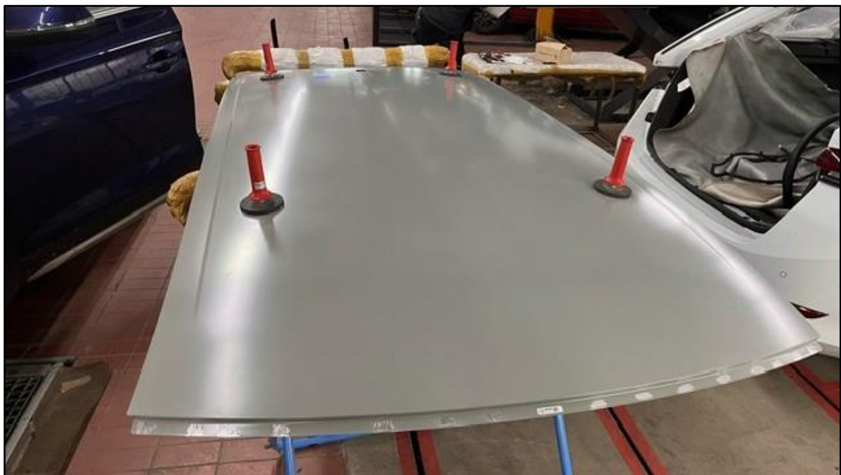
Bild 1: Dach Neuteil Anlieferungszustand ohne Löcher für Aufnahme Dachreeling links/rechts
